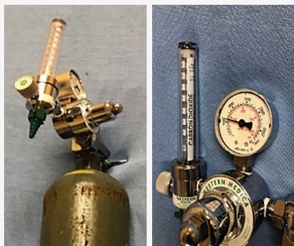
图2：外观基本相同的流量计，但有一张薄的二氧化碳标签（右）。
